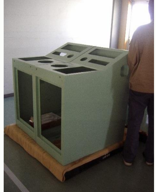
船舶用操舵装置筐体 (溶接一体構造)
