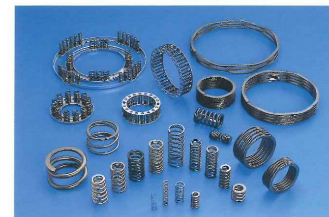
●コンプレッションスプリング(圧縮コイルばね) 線材または板材をらせん状に巻いて、生まれるねじり弾性エネルギーを利用するばねです。形状としては、一般的な円筒形、円錐形の他に、たる型やつづみ型などがあります。金属板に組み付けた形状で機能を果たす製品もあります。
