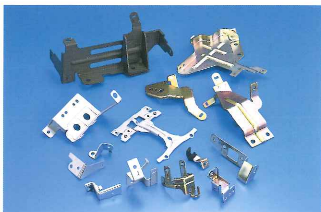
●ブラケット類 冷間圧延銅板などを使用し、プレス加工にて製作した製品です。自動車の車体に固定し、電装コネクタなどを保持します。
