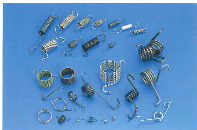
●テンション・トーションスプリング ばね用線材をらせん状に巻き、弾性エネルギーを利用するばねです。圧縮・引張り・ねじりコイルばねがあります。
