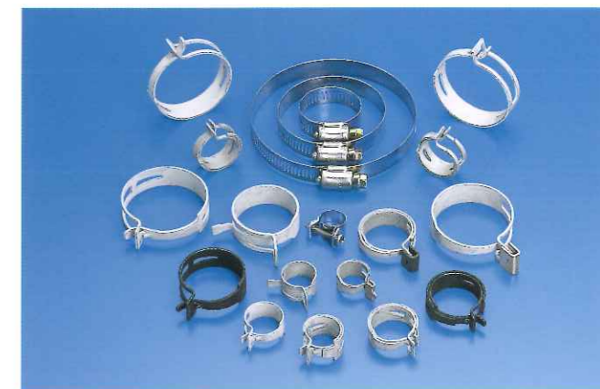
●クランプ部品 主にゴムホースとパイプの接合部で、洩れ、抜け止めの役目をします。目的や使用状況により形状が異なり、メインの板ばね式には、2重の強化タイプや納入時拡径(ホルダー有やホルダーレス)されたタイプがシリーズ化されています。
