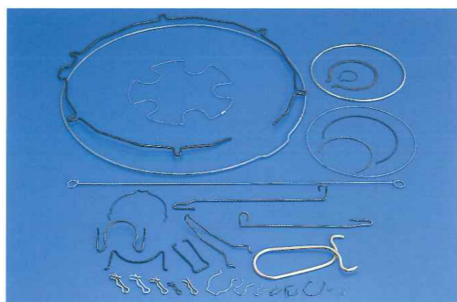
●ワイヤーフォーム ばね用線材をフォーミング加工にて製作したばねで自動車用タイヤのホイールキャップを固定するもの、クリップのように部品を保持するもの、両端をねじって使うトーションバー、規格化されたリテーナーなどがあります。
